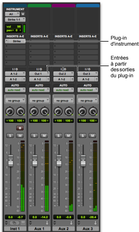
Plug-in d'instrument avec plusieurs sorties routées vers des pistes d'entrée auxiliaire
