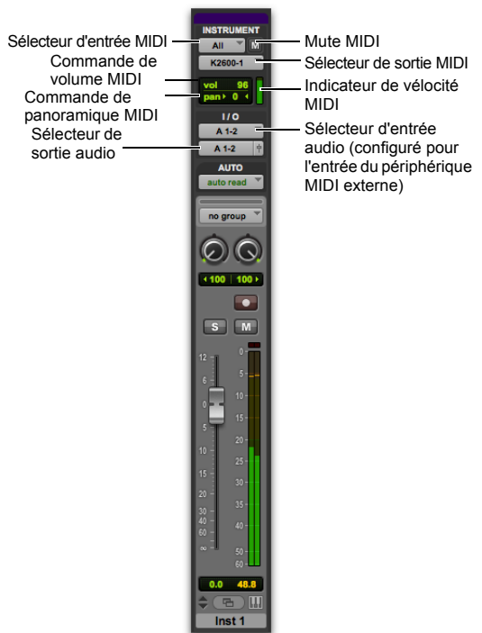
Piste d'instrument configurée pour le contrôle et le monitoring d'un instrument MIDI externe (K2600)
