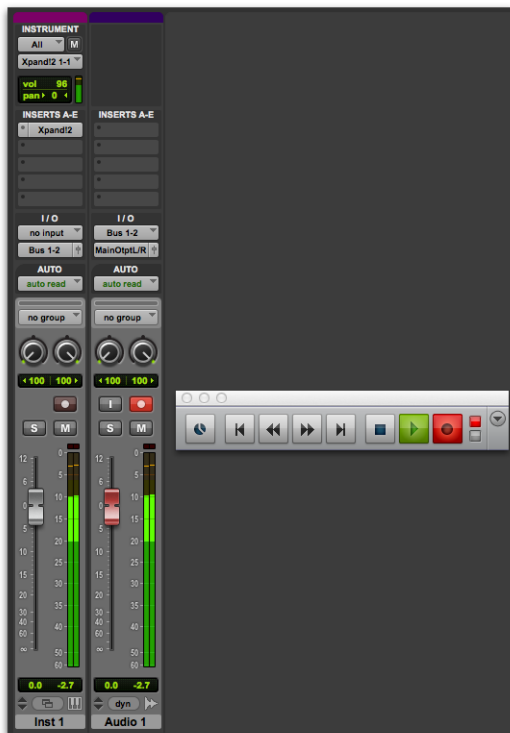
Enregistrement audio d'un bus provenant d'un plug-in d'instrument
