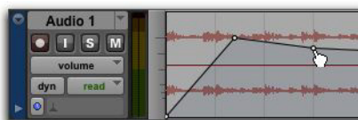
Création d'un point d'automatisation avec la Main
