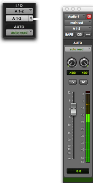
Ouverture d'une fenêtre Output de piste
