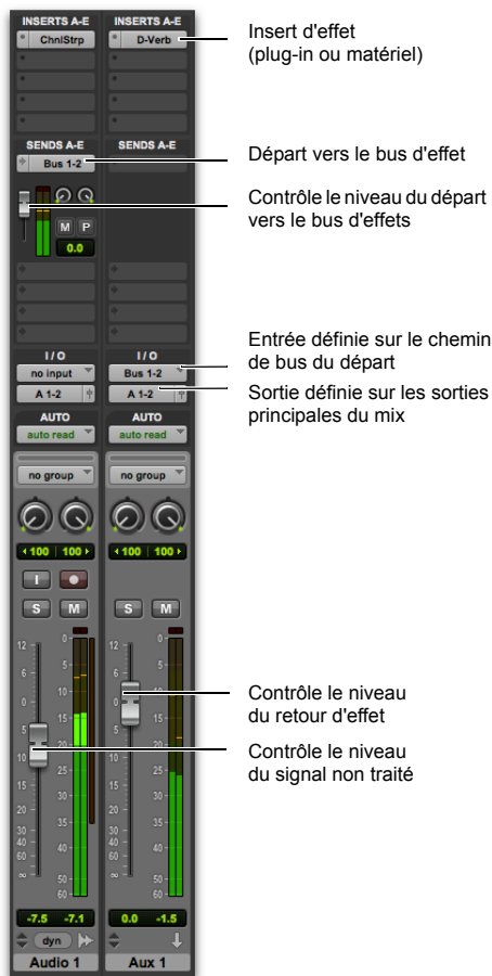
Configuration départ/retour pour un plug-in ou un insert matériel
