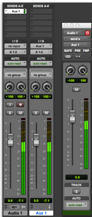
Nouvelle piste d'entrée auxiliaire avec assignation automatique du départ de piste audio au bus 1-2
